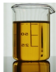
Fig.: XAO după test de coroziune în vas de sticlă (ASTM D 1384)
